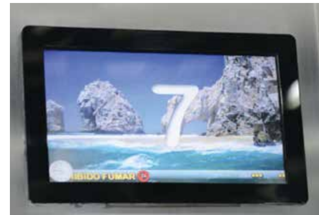
Ascensor con la novedad del indicador digital a color de 7"
